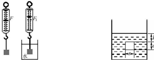
3. 阿基米德原理（排液法）： $F_{浮} = G_{排液} = \rho_{液} g V_{排}$
